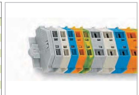
Klemmleiste mit Befestigungsflanschen, für Schraub- u. ä. Befestigungsarten, Befestigungslöcher Ø 3,2 mm (mit Montagefuß 209-123 auch auf Tragschiene DIN 35)
