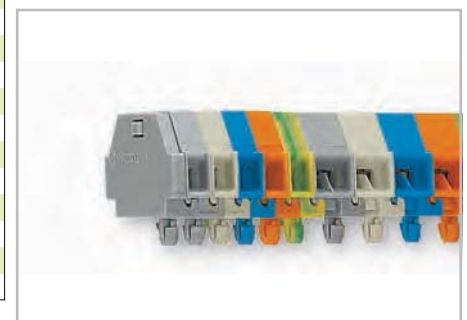
Klemmleiste mit Rastfüßen, für Blechdicke 0,6 ... 1,2 mm, Befestigungslöcher Ø 3,5 mm (auch auf Alu-Schiene 210-154 oder mit Montagefuß 209-120 auf Tragschiene DIN 35)
