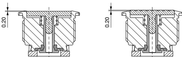
Die Einbautoleranz des Betätigers liegt zwischen 0,2 mm Überstand und 0,2 mm Unterstand zur Gehäusekante. Die Schräglage des Betätigers darf sich innerhalb dieser Toleranz bewegen.
