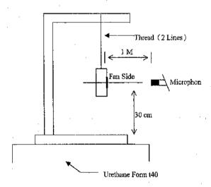
1 METER FROM MICROPHONE TO FAN INTAKE
