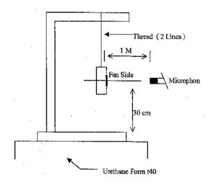
1 METER FROM MICROPHONE TO FAN INTAKE
